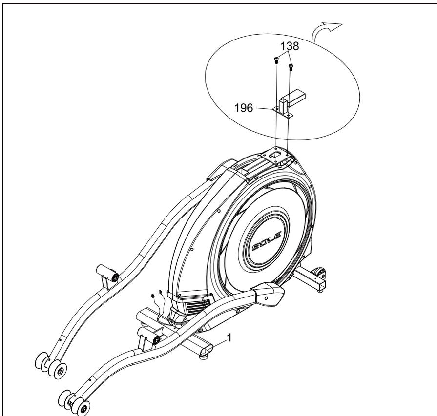
Utiliser la clé Allen M8\_L (**182**) pour débloquer les deux boulons à tête creuse, qui se trouvent sur le cadre principal pour fixer le tube du mât, afin de retirer et de disposer du stabilisateur d'expédition (**196**).
